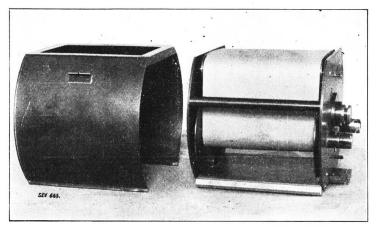
Fig. 4. Ansicht der Filmkassette für ca. 300 Aufnahmen in demselben Vakuum.
