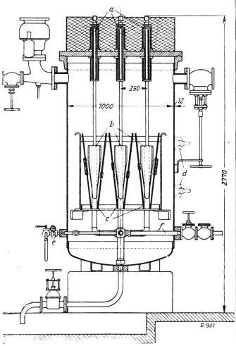
Schnitt durch einen Elektrodenkessel. a=Stromdurchführungen; b=Elektroden; c=Isolierkörper; d=Wasserkontakte; e=Abschlämmvorrichtung; f=Speiserohr.
