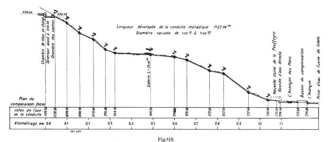
Profil en long de la conduite sous pression. — Echelle 1:10 000. — Longueur développée de la conduite métallique 1127,00 m. Diamètre variable de 1,20 m à 1,00 m.
