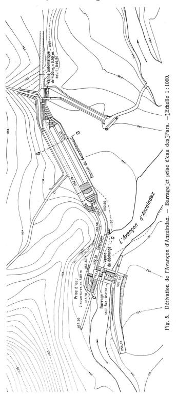
A l'origine de l'avant-canal, une grille d'entrée de 6 m de long protège les deux ouvertures de 3 m. Le vide entre les barreaux est de 30 mm. L'avant-canal, de 36 m, avec un déversoir de 8 m, arasé à 1152,00, conduit à l'entrée du dessableur et du canal d'hiver.
