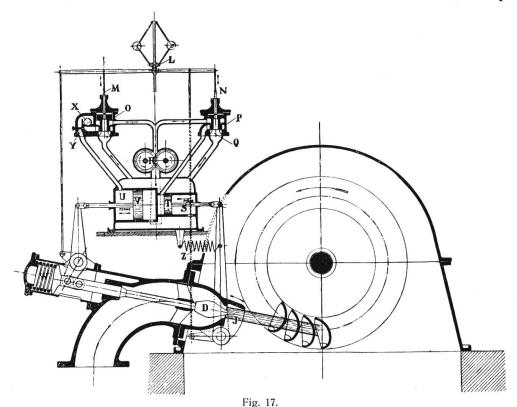
Schéma du régulateur de la turbine.
