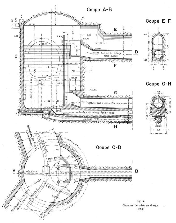
en face et à peu près à la hauteur de Gryon. Il est constitué par le réservoir de jonction des deux dérivations, soit une cuve circulaire et les deux tronçons de galerie à grande section aménagés pour l'accumulation journalière à l'extrémité des canaux d'amenée. La cuve circulaire a un diamètre utile de 10 m. Son fond est à la cote 1128,50, à 5 m en contre-bas du radier des galeries-réservoirs. Elle
