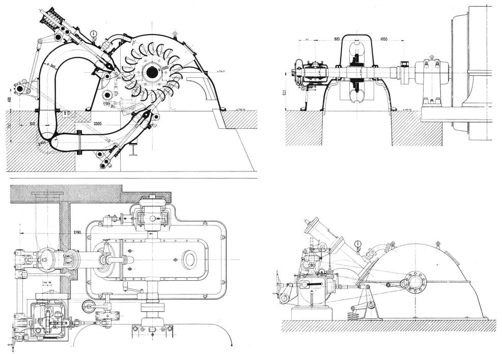
Fig. 16. Plan vue et coupes d'une des turbines Pelton, de 5000 ch. - Echelle 1:50. - Dessin des Ateliers de constructions méchaniques de Vevey.
