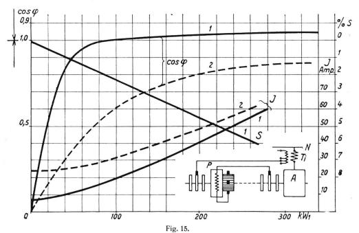
Caractéristiques du moteur asynchrone de 350 chevaux.
