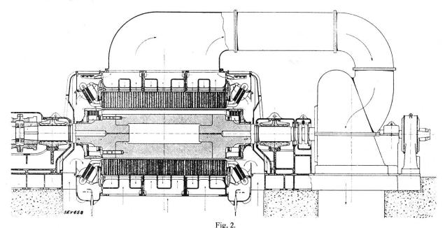
Turbo-alternateur triphasé pour la Hell Gate Power-Station.
