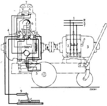
Fig- 8. Schéma de fonctionnement d'une dynamo à souder.
