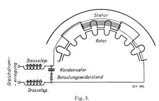
Schéma d'un alternateur à haute fréquence, de 10 kW, 20 000 pér./sec. Gleichstromerregung = excitation à courant continu.
