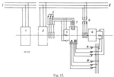
Dispositif de transformation de fréquence, avec excitatrice à courant triphasé et convertisseur de fréquence.
