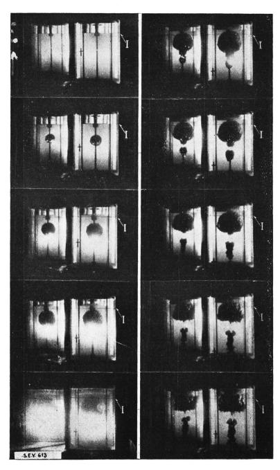
Fig. 25. Rupture dans l'huile cinématographiée au ralentisseur.
