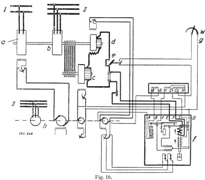
Dispositif de transformation de fréquence, avec réglage de la puissance par régulateur Tirril.
