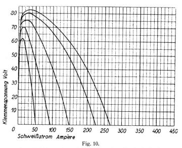
Caractéristiques d'une dynamo à souder, d'après la fig. 9. Klemmspannung=tension aux bornes; Schweisstrom=courant.
