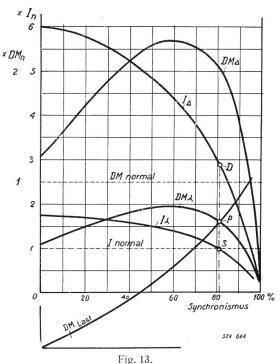
Allure du courant et du couple d'un moteur à courant triphasé à induit en court-circuit, pour schémas en étoile et en triangle. I = courant. DM = couple.
