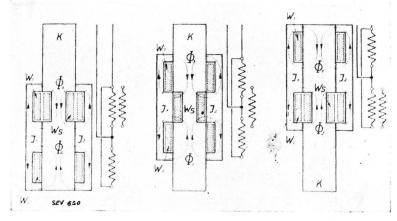
Fig. 21 a Principe du transformateur à coulisse.
