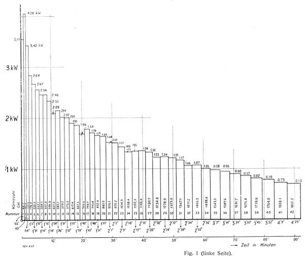
Diagramm zur Ermittlung des Wärmeinhaltes eines elektrischen Die Rechtecke stellen je die Verdampfungsarbeit für 70 cm³ Wasser = 44,1 Cal. dar, die Summe jedes Rechteck eingeschrieben.) Die Abszissen der Rechtecke bedeuten die Verdampfungszeit
