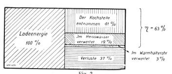
Fig. 2. Wärmebilanz der Aufladung und Entladung eines Seves-Herdes.
