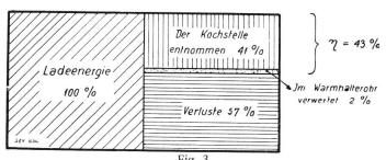
Fig. 3. Wärmebilanz der Aufladung und Entladung eines Nea-Herdes.
