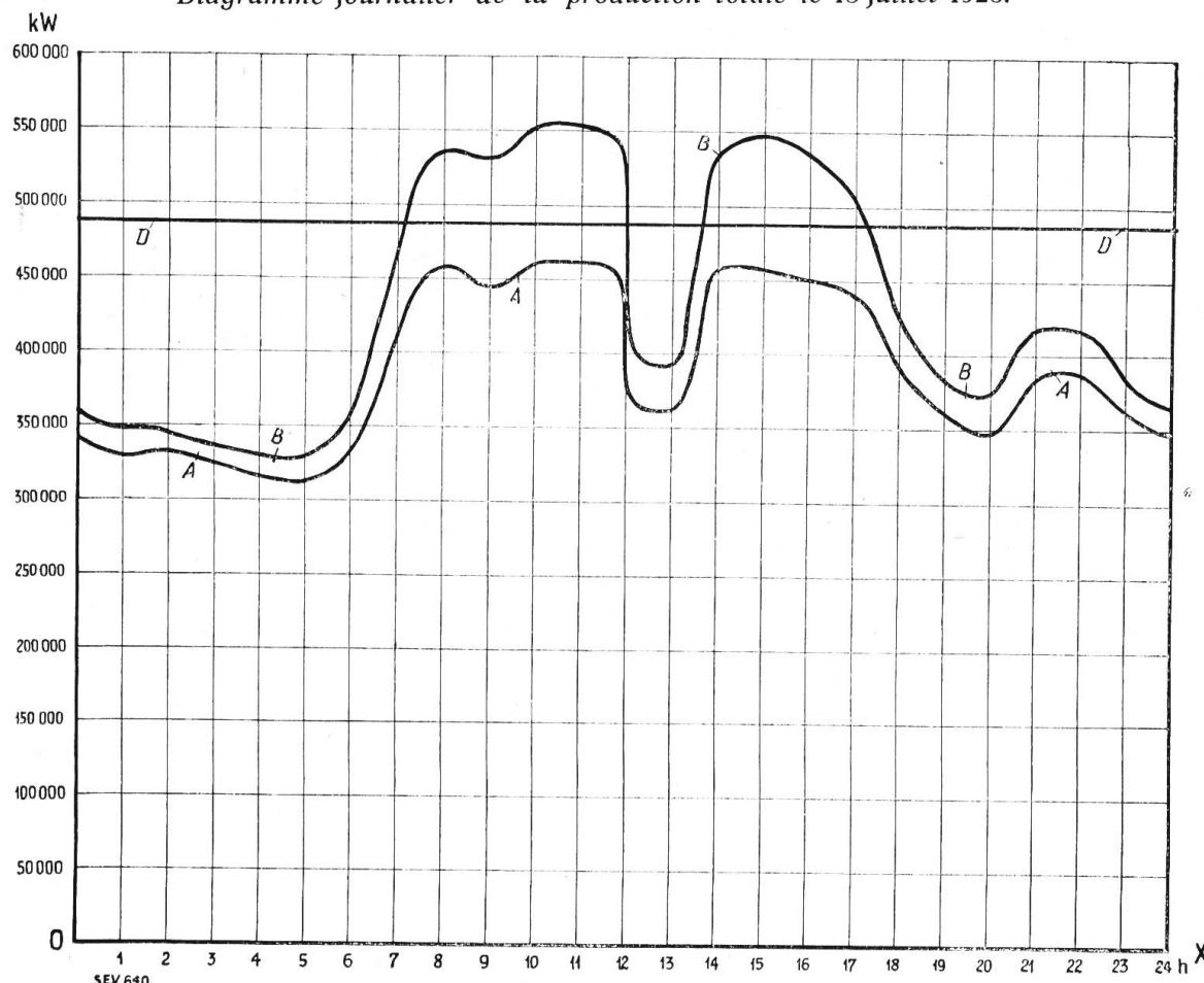
Leistung der Flusskraftwerke . . . . . =  $O \cdot X : A$  = Puissance utilisée dans les usines au fil de l'eau.
