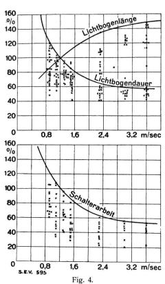
Abhängigkeit der Lichtbogenlänge, der Abschaltdauer und der Schalterarbeit von der Schaltergeschwindigkeit auf Grund von Abschaltversuchen mit Klotzkontakten bei 22000 kVA, f=50.
