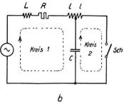
c = verteilte Leiterkapazität. l = verteilte Leitungsinduktivität.
