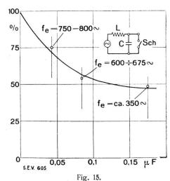
Abhängigkeit der Lichtbogenlänge von der Eigenfrequenz des Kurzschlusskreises. Einphasige Abschaltversuche bei 32 kV und 90 A. Ma-ximalwerte aus je 10 Schaltungen.
