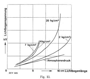
Zunahme der Lichtbogenspannung mit dem statischen Ueberdruck im Schalter. Abschaltversuche bei 2600 A<sub>off.</sub> und 4 kV mit zweifacher Unterbrechung. Schaltgeschwindigkeit 1,1 m/s.
