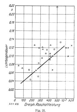
Lichtbogendauer bei den bis jetzt in 110 kV-Anlagen bekanntgewordenen Abschaltversuchen.
