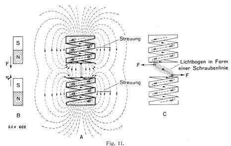
Schematische Erklärung der Eigenblasung bei Solenoidkontakten. Die Streufelder bewirken eine Ausblasung des Lichtbogens in Form einer Schraubenlinie.
