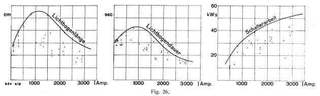
Abhängigkeit der Wirkung einer Druckkammer vom Kurzschlusstrom bei gegebener Spannung. Versuche bei 4 kV.
