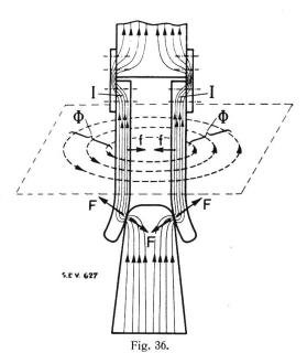
Schematische Darstellung der Anordnung aus parallelen Fingerkontakten bezw. Tulpenkontakten mit getrennten Segmenten.
