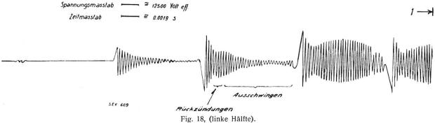
Einfluss von Parallelkapazitäten zu Oelschaltern auf den Abschaltvorgang. Schalters. Kapazität angeschlossen
