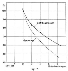
Begünstigung des Abschaltvorganges durch Vielfachunterbrechung. Zur Ableitung dieser Kurven wurden Versuchsreihen von 50-80 Schaltungen bei 24000 kVA gemacht.
