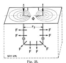
Schematische Erklärung der Kontaktabhebungserscheinungen im Oelschalter: Elektrodynamische Kräfte im Schalter suchen die Stromschleife zu öffnen.
