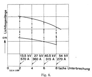
Untersuchung der Lichtbogenlänge bei gegebener Spannung pro Unterbrechungsstelle. Kugelkontakte, Abschaltgeschwindigkeit 12 m/sec.
