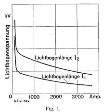
Statische Strom-Spannungs-Charakteristiken des Wechselstromlichtbogens in Oel für zwei verschiedene Lichtbogenlängen.
