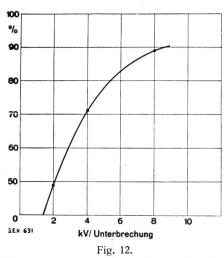
Verkleinerung der Lichtbogendauer infolge der Eigenblasung von Solenoidkontakten gegenüber Klotzkontakten. Versuche bei 3000 A<sub>eff.</sub> Abschaltstrom und 1,2 m/sec. Abschaltgeschwindigkeit.
