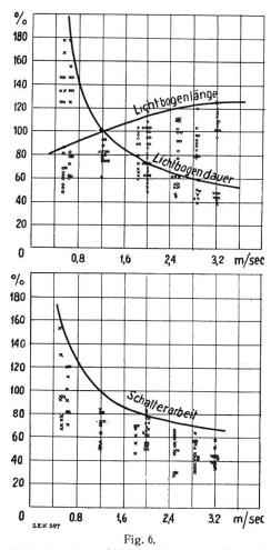
Abhängigkeit der Lichtbogenlänge, der Abschaltdauer und der Schalterarbeit von der Schaltgeschwindigkeit auf Grund von Abschaltversuchen mit Kugelkontakten bei 2200 kVA, f=50.
