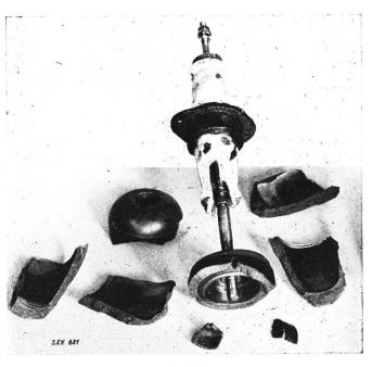
Fig. 29. Eine bei der Abschaltung von 20000 kVA explodierte Druckkammer aus Isoliermaterial.
