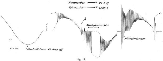
Einfluss von Parallelkapazitäten zu Oelschaltern auf den Abschaltvorgang.  $C=0.177\cdot 10^{-6}\,F$ . Kathodenoszillogramm des Kurzschlusstromes in D. Kapazität angeschlossen vor der Drosselspuhle. (Fig. 17 a.)
