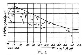
Lichtbogendauer in Funktion des Abschaltstromes: Einfluss der magnetischen Blasung (nach J. D. Hilliard, Gen. El. Rev. 1924, S. 822).
