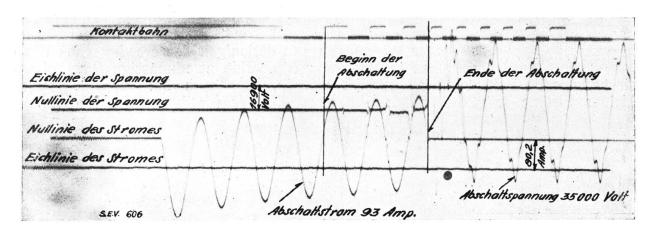
Fig. 16. Einfluss von Parallelkapazitäten zu Oelschaltern auf den Abschaltvorgang.  $c=0,173\cdot 10^{-6}\ F.$
