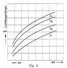
Abhängigkeit der Lichtbogenlänge bei gegebenem Strom von der Abschaltspannung. Mit  $I_1$ ,  $I_2$ ,  $I_3$ ,  $I_4$  sind Ströme in wachsender Reihenfolge bezeichnet.
