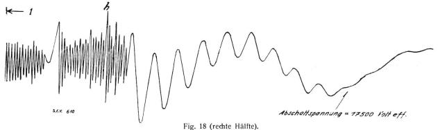
$c = 0,177 \cdot 10^{-6}$  F. Kathodenoszillogramm der Spannung an den Klemmen des vor der Drosselspule (Fig. 17a).
