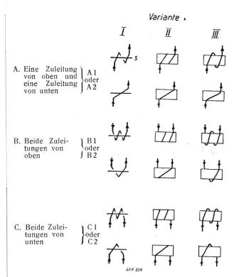
erste Variante Magnetkern durch Strich angedeutet. Zweite und dritte Variante mit Rechteck für Magnetkern.)
