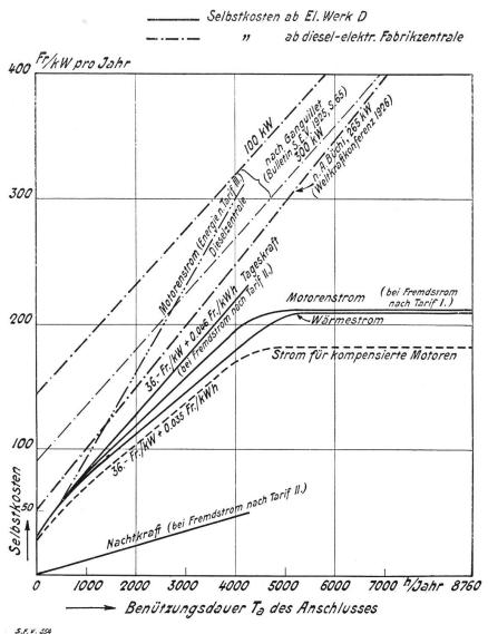
Fig. 5. Selbstkosten für Motoren- und Wärmestrom ab Werk D und Vergleich mit dieselelektrischer Energie ab Fabrikzentrale.
