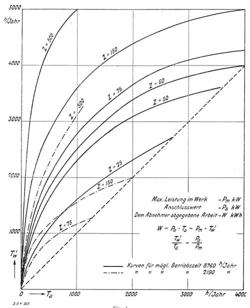
Fig. 4. Kurven der Benützungsdauer  $T_{\rm w}$  im Werk in Abhängigkeit von Benützungsdauer  $T_{\rm a}$  der Anschlüsse (nach Prof. Kummer).
