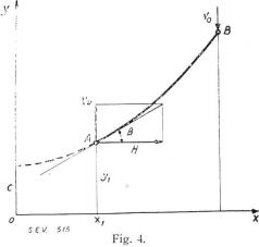
Aus Fig. 4 erhalten wir  $V_u = H \lg \beta = H \left| \frac{dy}{dx} \right|_{x = x_1}$ Gleichung der Kettenlinie:
