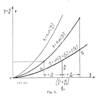
Ein Vergleich der Ausdrücke (4) und (6) zeigt, dass sie durch dieselbe Kurve dargestellt werden können. Man hat nämlich nur die Ordinaten der Kurve (4) mit dem für einen Leitungsabschnitt konstant gehaltenen Horizontalzug H zu multiplizieren, um zur Kurve 6 zu gelangen. Da H und c für ein grösseres Leitungsstück konstant sind, braucht die Kurve auch nur einmal aufgezeichnet zu werden.
