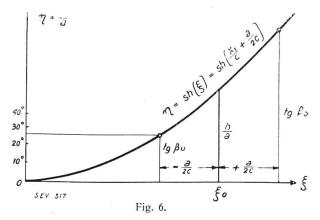
Subtraktion resp. Addition von  $\frac{a}{2c}$  erhalten wir eine neue Abszisse und für diese in derselben Kurve die entsprechende Ordinate als  $\lg \beta_{\mathfrak{u}}$  resp.  $\lg \beta_{\mathfrak{o}}$ . Wir bringen somit auf der  $\eta$  Axe eine  $\beta$  Teilung an und können dann die Neigungswinkel direkt ablesen (siehe Fig. 6).
