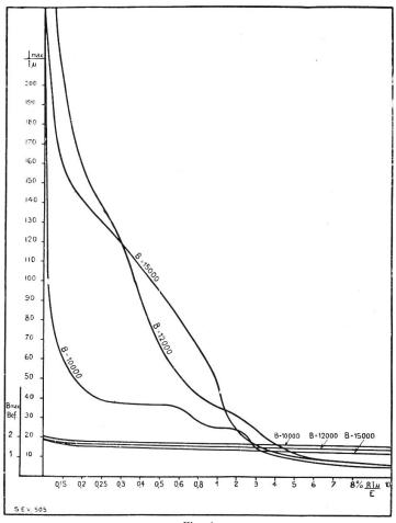
Fig. 4. Variation de l'à-coup de courant en fonction de la chute ohmique. Pour  $B=10\,000$  CGS sans magnétisation rémanente —at/cm normaux = 4 12000 CGS sans magnétisation rémanente —at/cm normaux = 8 15000 CGS sans magnétisation rémanente —at/cm normaux = 34
