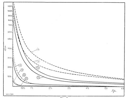
Fig. 3. Variation des at/cm en fonction de la résistance ohmique. Pour  $B=10\,000$  CGS sans magnétisation rémanente —at/cm normaux = 4 12\,000 CGS sans magnétisation rémanente —at/cm normaux = 8-12 15\,000 CGS sans magnétisation rémanente —at/cm normaux = 34-64 et 15\,000 CGS avec induction rémanente —at/cm normaux = 34-64 de 5000 CGS.
