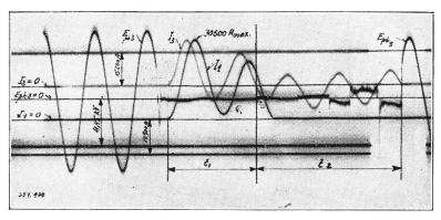
Fig. 8. Begünstigung des Abschaltvorganges durch asymmetrischen Stromverlauf. Abschaltung eines dreiphasigen Kurzschlusses bei 8,5 kV. Die Löschung des Stromes  $I_1$  erfolgt bei ersterem um  $90^{\circ}$  phasenverschobenen Nulldurchgang nach 0,04 sec. Die beiden andern Phasen brennen nachher noch während 0,055 sec.:  $t_1 = 0,034 \text{ sec.}, \ t_2 = 0,06 \text{ sec.}$
