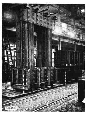
Fig. 5. Fertig montiertes Eisengestell in der Werkstätte.
