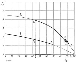
Fig. 7 a (oben) und 7 b (unten). Anlaufvorgang bei reinen Fliehkraft-Kupplungen in Funktion der Tourenzahl. Kurve  $M_K$ : Durch die Kupplung bei Gleiten übertragbares
