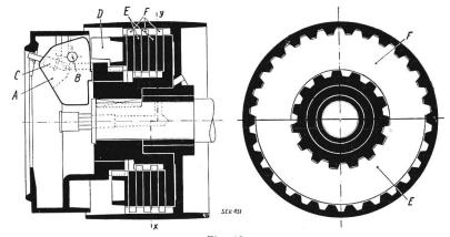
Fig. 12. Schematische Darstellung der Kupplung III. Fliehgewicht. E: Reibflächen im Eingriff mit dem antreibenden Teil
