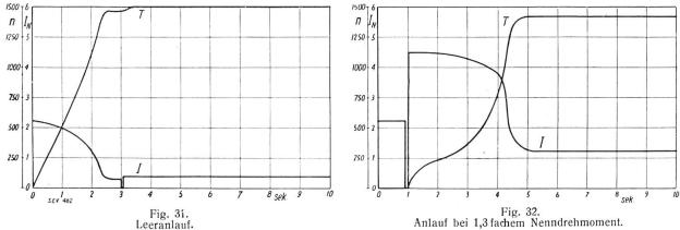
Zeitlicher Verlauf des Statorstromes (I) und der Rotortourenzahl (T) bei Einschalten mittels Stern-Dreieck-Schalter.
