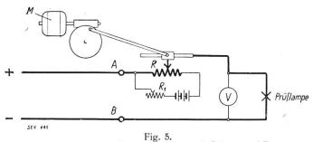
Versuchsanordnung zur Erzeugung von nach Grösse und Frequenz regulierbaren Schwankungen des Glühlampenlichtes. (M=Antriebsmotor, R=Gleitwiderstand, R<sub>1</sub>=Regulierwiderstand.)
