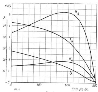
Fig. 1. Drehmoment  $(M_{\wedge} \text{ und } M_{\Delta})$  und Statorstrom  $(I_{\wedge} \text{ und } I_{\Delta})$  eines Käfiganker-Motors in Funktion der Tourenzahl.
