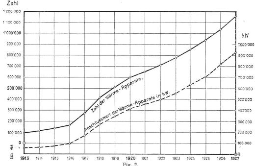
Stand der Anschlüsse an elektrischen Wärmeapparaten für den Haushalt in der Schweiz nach Zahl und Anschlusswert je auf Ende der Jahre 1913 bis 1927
