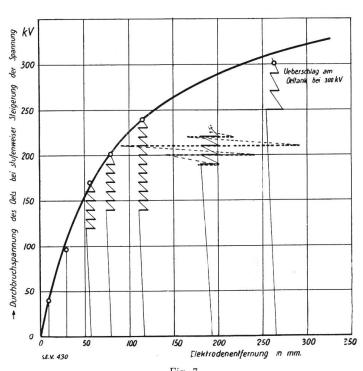
Fig. 7. Schlagweite in kaltem Oel mit "Di-El" Stäben als Isolierdistanz. Metallfassung Elektrode c mit r=15 mm Abrundung. Bei den Zickzacklinien in der Figur bedeutet ein horizontaler Strich von 2 mm eine Rast von  $^{1}/_{2}$  Minute in der Steigerung der Prüfspannung. Die metallischen Fassungen sind von der Staboberfläche durch einen isolierenden "Di-El" Ring um 5 mm radial distanziert.
