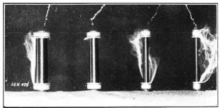
Fig. 5 und 6. "Di-El" Stäbe mit stark gerundeten Elektroden. Distanz 295 mm. Fig. 5. Bei 117 kV (untere Grenzspannung). Fig. 6. Bei 120 kV (obere Grenzspannung).
