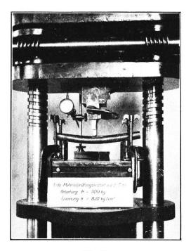
Fig. 11. Biegeproben mit "Di-El" Stäben.
