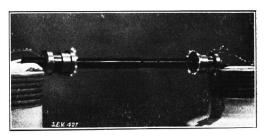
"Di-El" Stab mit 345 mm Distanz bei 185 kV (=  $90 \, ^0/_0$  der Ueberschlagsspannung).
