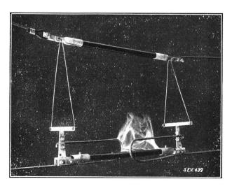
Fig. 12. Streckentrenner der S. B. B. mit "Di-El" Isolierstab; Ueberschlag bei 95 kV.
