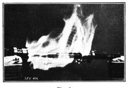
Fig. 3. "Di-El" Stab. Distanz = 245 mm; Ueberschlag bei 150 kV.
