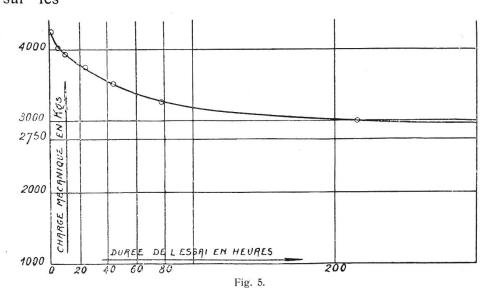
Durée d'un isolateur du modèle 9985 de la "Compagnie Générale d'électro-céramique" en fonction de la charge mécanique, pour une tension électrique de 50 kV.
