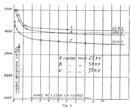
Courbe de la durée d'un isolateur du modèle 9985 de la "Compagnie Générale d'électro-céramique" en fonction de la charge mécanique, pour des tensions électriques de 25, 50 et 75 kV.
