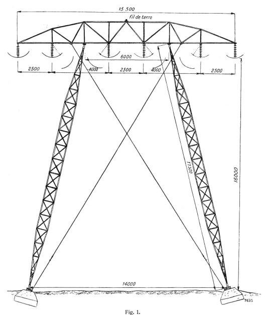
Pylône-chevalet articulé Darrieus pour ligne triphasée double à 1201kV (six conducteurs en nappe horizontale).
