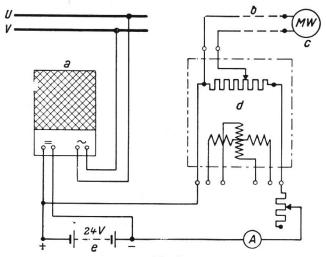
Fig. 5. Schaltung der Fernmesseinrichtung bei Einzelmessungen.
