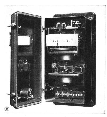
Fig. 1. Geber-Instrument, Gehäuse geöffnet.
