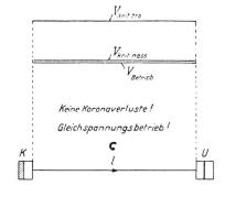
c) Anzustrebender konstanter Spannungsverlauf V von Leerlauf bis Volllast nahe und parallel der kritischen Durchbruchspannung bei nassem Wetter, möglich durch kapazitive und induktive Blindlastregulierung am Ende der Fernleitung.
