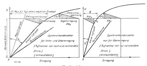
Fig. 8 und 8a. Leerlaufcharakteristiken von Synchronblindleistungsmaschinen.
