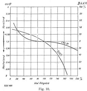
Leistungsfaktor und Blindleistungsaufnahme des Synchronmotors mit Anlaufwicklung.
