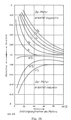
Leistungsfaktor eines Asynchronmotors mit fremderregter Drehstrom-Erregermaschine bei verschiedenen Erregerspannungen.
