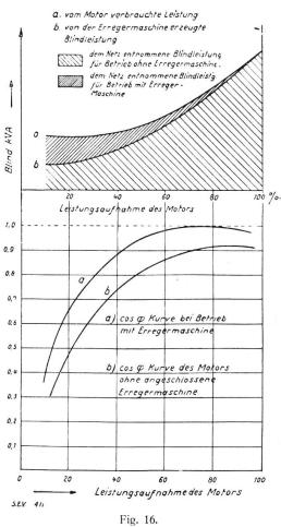
Leistungsfaktorkorrektur durch eigenerregte Drehstrom-Erregermaschine.
