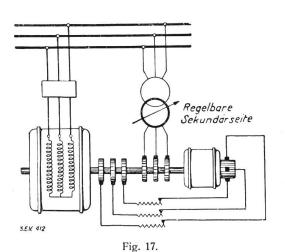
Prinzipielle Schaltung eines Asynchronmotors mit fremderregter Drehstrom-Erregermaschine.
