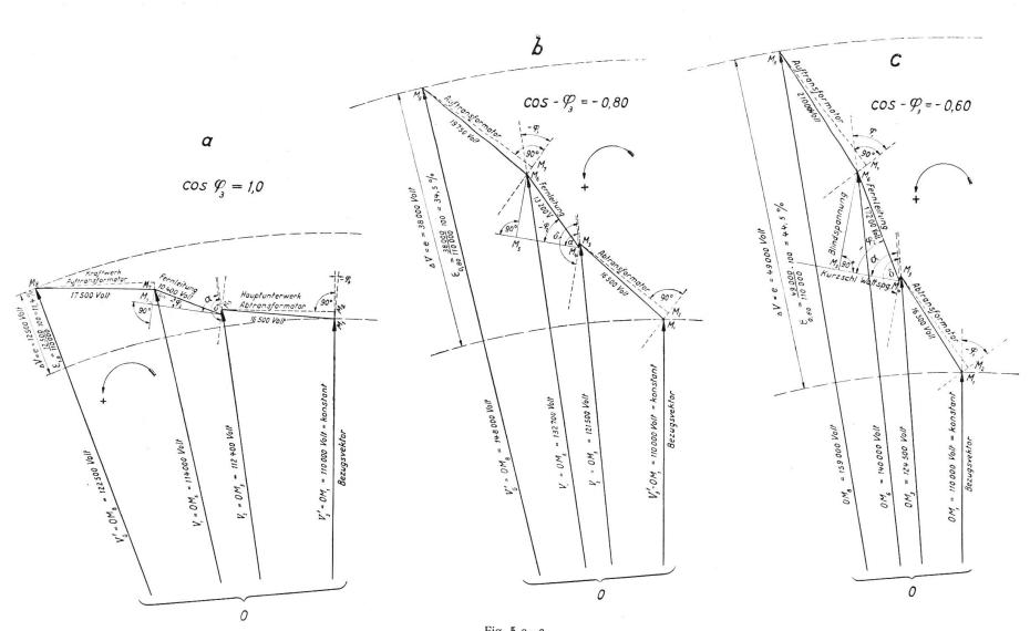
Fig. 5 a-c. Spannungsvektordiagramme für die gesamte Leistungsübertragung auf 100 km bei der Netzvollast  $P_3 = \sim 30\,000$  kW und verschiedenen Netzleistungsfaktoren cos  $\varphi$  ohne Phasenkompensation.
