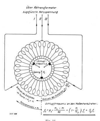
Erzeugung von kapazitiver Blindleistung im entgegen dem Drehfeld rotierenden Kollektoranker.
