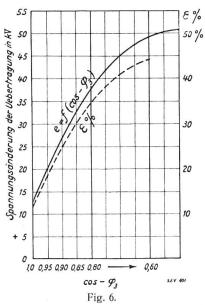
Kurve der Spannungsänderung in Funktion des Leistungsfaktors bei konstanter Vollast.
