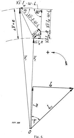
Vektordiagramm für Strom und Spannung, den Spannungsabfall einer Leitung darstellend.
