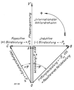
Fig. 1. Leistungsdiagramm einer Wechselstromübertragung.
