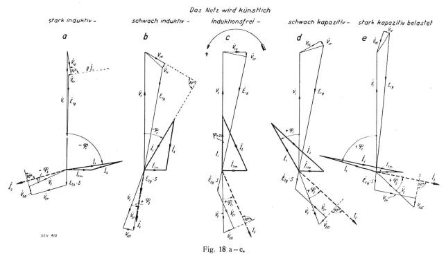
Vektordiagramme mit verschiedenen Phasenverschiebungen  $\pm \varphi_1$  eines Drehstrom-Asynchronmotors mit fremderregter Drehstrom-Erregermaschine.
