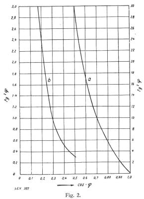
Die relativen Blindlastverluste in Funktion des Leistungsfaktors  $\cos \varphi$ . Ordinaten von Kurve a links, von Kurve b rechts ablesen.
