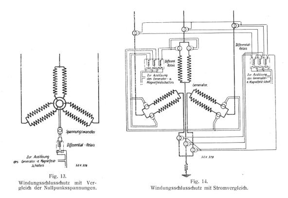
Differentialvergleich der Ströme in diesen verschiedenen Wicklungsteilen einer und derselben Phase (Fig. 14). Durch Kombination dieser innern Differentialschaltung mit der Differentialschaltung über dem ganzen Generator, erhält man einen Schutz, der auf alle Fehler innerhalb der Maschine anspricht.
