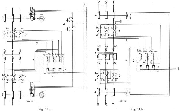
Differentialschutz bei Transformatoren in  $\gamma/\gamma$  Schaltung.
