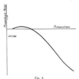
Verlauf der Fehlerkurve eines Stromwandlers.
