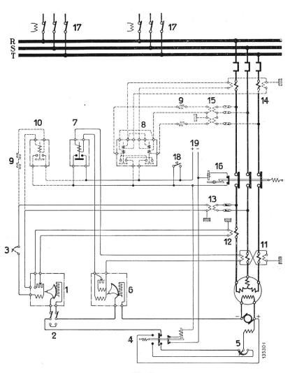
Fig. 3. Generatorschutz mit Rückwattrelais.
