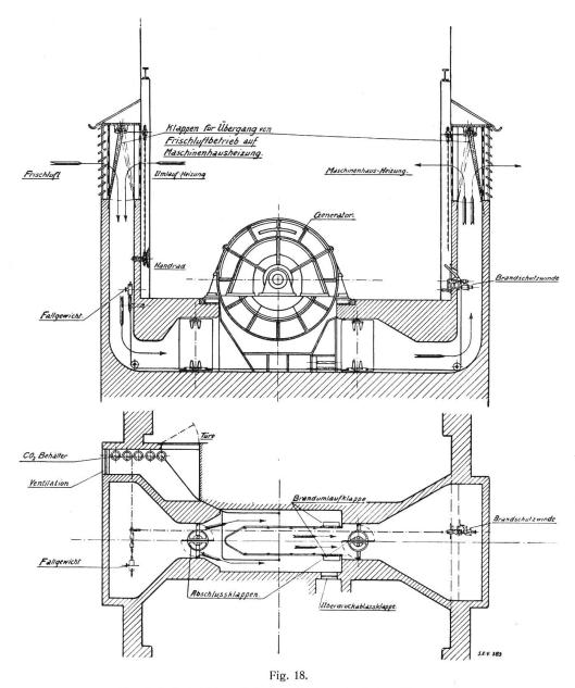
Brandschutzeinrichtung bei einem horizontal-achsigen Generator.
