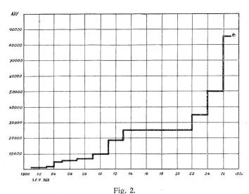
Entwicklung der Einheitsleistung bei Generatoren mit Dampfturbinenantrieb.
