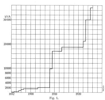
Entwicklung der Einheitsleistung bei Generatoren mit Wasserturbinenantrieb.
