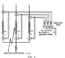
Erdschlusschutz mit Differentialrelais bei Erdung des Nullpunktes.
