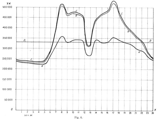
Verlauf der wirklichen Gesamtbelastung am 15. Dezember 1926 der Elektrizitätswerke der Schweiz, welche in eigenen Erzeugungsanlagen über mehr als 1000 kW verfügen, d.h. ca. 94% der Gesamtproduktion.
