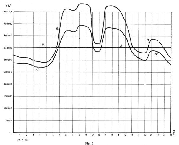
Verlauf der wirklichen Gesamtbelastung am 15. Juni 1927 der Elektrizitätswerke der Schweiz, welche in eigenen Erzeugungsanlagen über mehr als 1000 kW verfügen, d. h. ca.  $94\,^{0}/_{0}$  der Gesamtproduktion.
