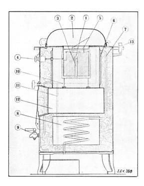
Fig. 16. Schnitt durch den Seves-Speicherherd.
