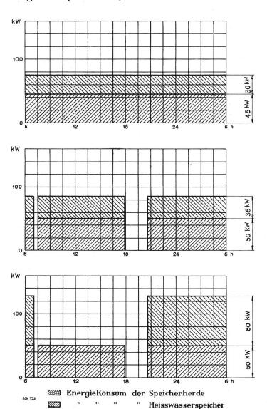
Fig. 1, 2 und 3. Schematische Belastungsdiagramme bei 100 angeschlossenen Wohnungen mit Speicherherden und Badeheisswasserspeichern von 75 l.
