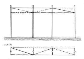
Eine nach diesem Prinzip ausgeführte Leitung von 20 km Länge, mit drei Stahlaluminiumdrähten No. 35, soll seit drei Jahren störungslos im Betrieb sein. Die Spannweite beträgt 100 bis 110 m.
