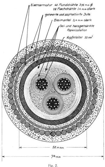
Fig. 2. Kabelquerschnitt (natürliche Grösse).
