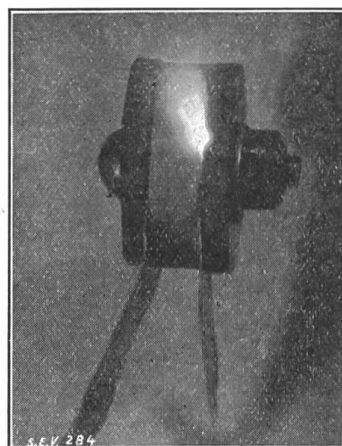
Fig. 19. Photo eines Silitrings mit 200 \Omega Nennwert, während der 5 Mal je \frac{1}{50} sec auf 700 V eingeschaltet wurde in Abständen von je ca. 15 sec.
