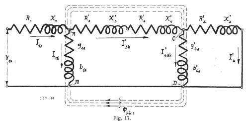
Ersatzschaltung beim Kurzschlusszustand bei Primärspannung.
