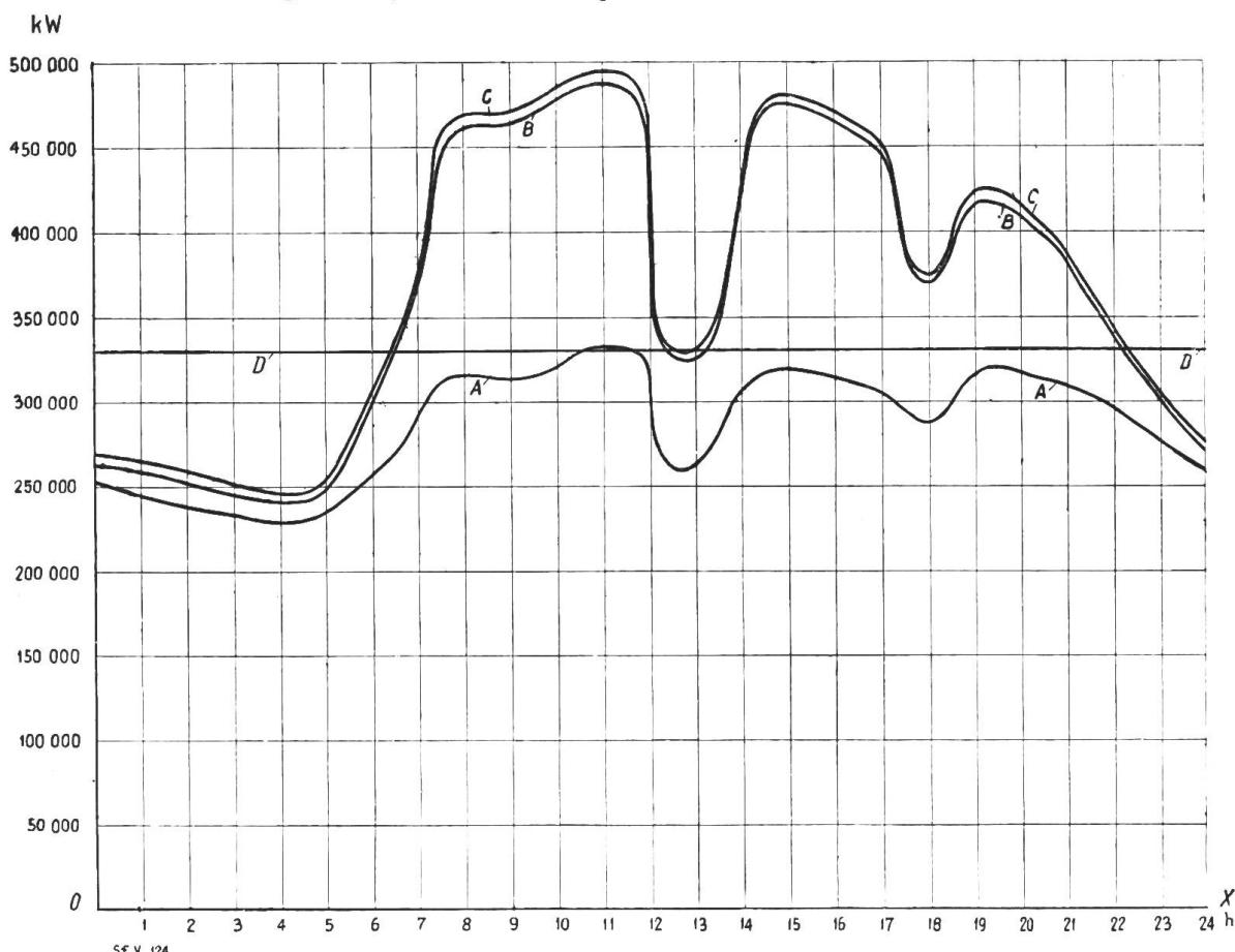
Leistung der Flusskraftwerke . . . . . =  $O \times A$  = Puissance utilisée dans les usines au fil de l'eau
