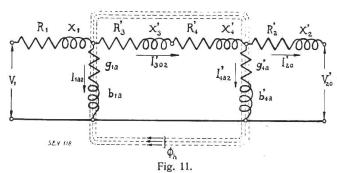
Ersatzschaltung bei Sekundärspeisung im Leerlauf.
