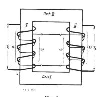
Fig. 1. Wicklungsschema des Kaskadentrans-formators mit zwei gegeneinander geschalteten Kaskadenwicklungen.
