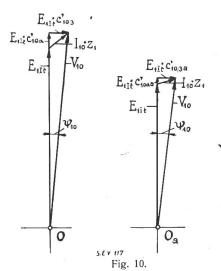
Diagramm der Leerlaufspannungen in der Primärwicklung
