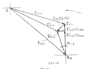
Fig. 9. Leerlaufdiagramm der treibenden Spannung im Kaskadenkre's für  $w_3 < w_4$  und  $I_{30} < 0$ .
