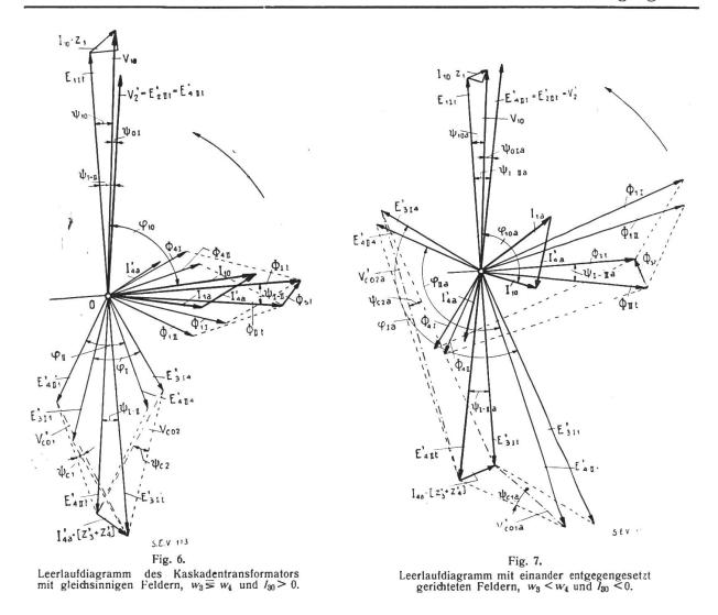
Diese Erscheinung hat aber wiederum eine andere gute Wirkung, indem bei Belastung des Transformators der Vollastkaskadenstrom um den Betrag des Leerlaufkaskadenstromes verringert wird und damit der Spannungsabfall ab- und die Sekundärspannung etwas zunimmt.
