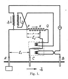
takt K. Wenn das Instrument stromlos ist, müssen  $E_1$  und  $E_2$  entgegengesetzt gleich, also  $E_1+E_2=0$  sein. Zu gleichen Strömen gehören aber nur dann gleiche Spannungsabfälle, wenn die Widerstände gleich sind, d. h. das abgegriffene Stück auf dem Vergleichswiderstand ist gleich dem gesuchten Widerstand der Erdelektrode. Durch eine einfache Umschaltung des Stromwandlers, nach der  $I_2=10\,I_1$  ist, wird der Messbereich ohne weiteres im Verhältnis 1:10 erhöht.
