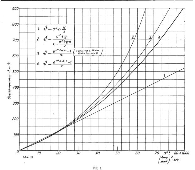
Vergleich einiger Formeln zur Berechnung der Uebertemperatur bei kurzzeitiger Belastung von Kupferleitern.
