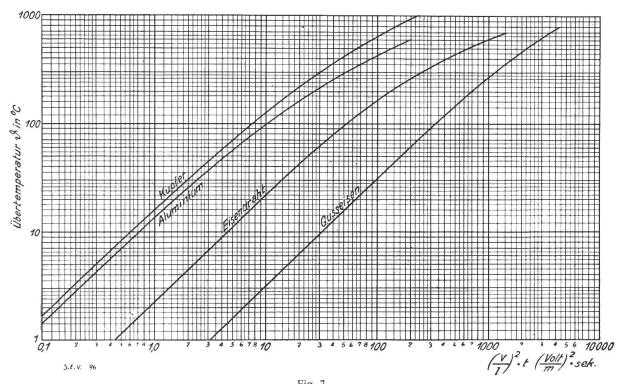
Kurven zur Ermittlung der Uebertemperatur von verschiedenen Leitermaterialien bei kurzzeitiger ohmscher Belastung mit konstanter Spannung.
