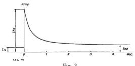
Fig. 3. Verlauf des Kurzschlusstromes. In = Normalstrom. Ika = Stosskurzschlusstrom. Ikd = Dauerkurzschlusstrom.
