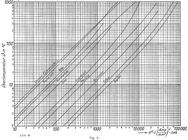
Kurven zur Ermittlung der Uebertemperatur von verschiedenen Leitermaterialien bei kurzzeitiger Belastung mit konstanter Stromstärke.
