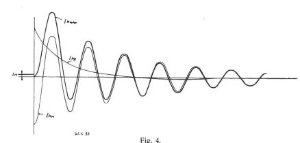
Asymmetrischer Kurzschluss. Zusammensetzung von Gleich- und Wechselstromanteil zum totalen Kurzschlusstrom.
