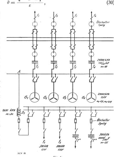
Fig. 6. Schaltungsschema einer Zentrale.
