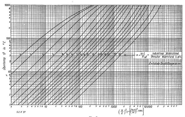
Fig. 8. Kurven zur Ermittlung der Uebertemperatur von Spulen aus Cu-Draht bei kurzzeitiger induktiver Belastung und konstanter Spannung. Ausgangstemperatur =  $20^{\circ}$  C. ( $\rho$  für Cu, bei  $20^{\circ}$  C = 0,0175  $\Omega/m$  u. mm²).
