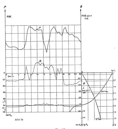
Fig. 12. Tagesdiagramm der Wirk- und Blindlast, sowie des Phasenwinkels am Anfang der Leitung, bei zeitlich abgestufter künstlicher Kompensation (Strecke B tg  $\varphi_2=0,026$ ).
