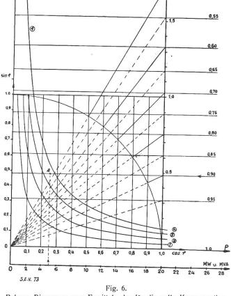
Polares Diagramm zum Ermitteln der für die volle Kompensation notwendigen Anzahl Phasenschieber bestimmter Blindleistung.
