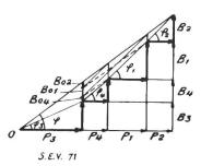
Fig. 4. Verteilung der Blindlastkomponente  $B_0$  auf die Generatoren 1, 2 und 4; Wirklast unverändert,  $\cos \varphi = 0.8$ .  $B_{01} + B_{02} + B_{01} = B_0$ .  $\varphi_1 = \varphi_2 = \varphi_1 > \varphi_3$ .
