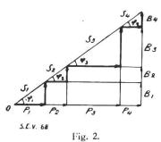
Proportional veränderte Wirk- und Blindlast der 4 Generatoren:  $\cos \varphi = 0.8$ .  $\varphi_1 = \varphi_2 = \varphi_3 = \varphi_4 = \varphi.$
