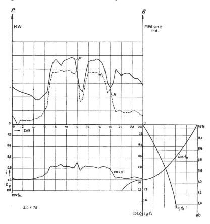
Fig. 11. Tagesdiagramm der Wirk- und Blindlast, sowie des Phasenwinkels am Anfang der Leitung vor Einführung der künstlichen Kompensation (Strecke B tg  $\varphi_2=0,026$ ).
