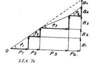
Fig. 3 a. Generator 3 läuft mit verkleinerter Erregung; Blindlastkomponente  $B_0$ ungedeckt;  $\cos \varphi = 0.8$ .  $\varphi_1 = \varphi_2 = \varphi_4 > \varphi_3$ .
