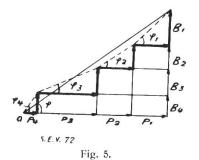
50% Wirklast von Generator 4 auf Generator 2 übertragen; Blindlastkomponenten unverändert.
