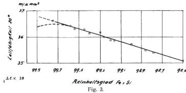
Abhängigkeit der Leitfähigkeit nach Glühung bei 3000 C vom Reinheitsgrad des Al.
