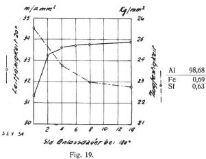
bei einer Leitfähigkeit von 34,5 m/2 mm² noch eine Zugfestigkeit von 26 kg/mm²
