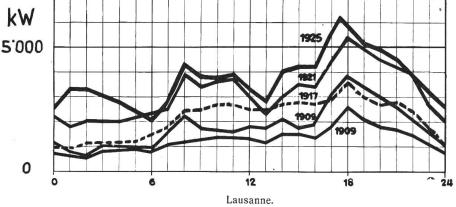
Fig. 6 bis 8. Entwicklung der Leistungskurven an den höchstbelasteten Tagen für die Städte Bern, Genf und Lausanne.
