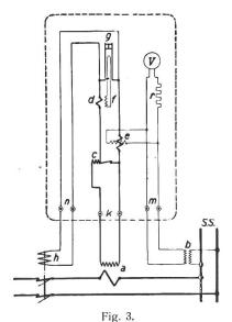
Schaltung des N-Relais (Wechselstromauslösung).
