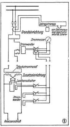
Fig. 3. Schema der Relaisprüfeinrichtung.
