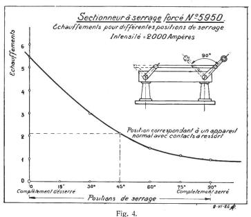
Graphique d'essai d'un sectionneur.
