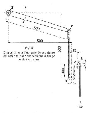
poulies a et b selon fig. 3; une extrémité du conducteur est tendue par un poids de 1 kg, l'autre extrémité est fixée en c à un dispositif de traction comportant un axe d et un bras de levier dc tournant sur son axe à raison de 10 tours par minutes. Le conducteur est ainsi soumis à un mouvement de va-et-vient intéressant une longueur de 1 m, la vitesse maximum du mouvement étant 0.52 m/sec.
