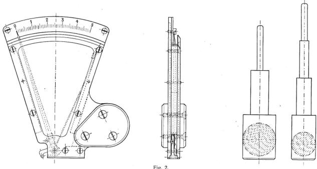
Instrument pour mesurer l'épaisseur de caoutchouc de conducteurs isolés.
