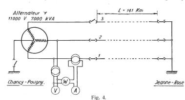
Schéma pour la mesure de la résistance et de la réactance avec du courant alternatif 11 000 V.
