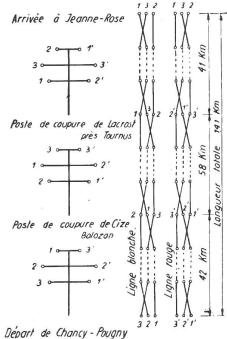
Schéma de permutation des phases, le long de la ligne.
