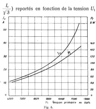
Caractéristiques à vide côté basse tension pour un groupe transformateur triphasé  $3\times4666$  kVA,  $11\,000/120\,000$  volts,  $\Delta/\gamma$ .
