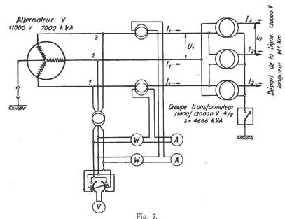
Schéma de mesure lors de la mise sous tension de la ligne.
