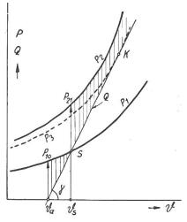
Dielektrische Verluste P und abgeleitete Wärmeleistung Q in Funktion der Temperatur.
