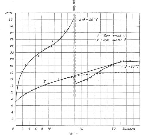
Dielektrische Verluste in Funktion der Zeit der Versuchsrohre nach Fig. 11, gemessen unter Oel von 90°C bei 40 kV, f=50.
