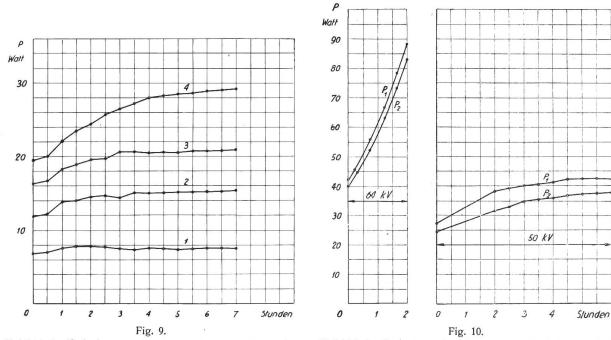
Dielektrische Verluste von vier Rohren derselben Type, aber verschiedener Güte, in Funktion der Zeit. Rohrunterteil in Oel von  $90\,^{0}$  C, Messung bei 65 kV, f=50.
