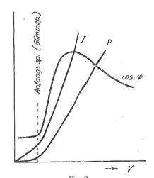
Fig. 2. Verlust P, Strom I u. Verlustfaktor  $\cos \varphi$  in Funktion der Spannung einer Serieschaltung zweier Glasplatten mit einer zwischenliegenden glimmenden Luftschicht, gemessen bei 20  $^{0}$  C, f = 50.
