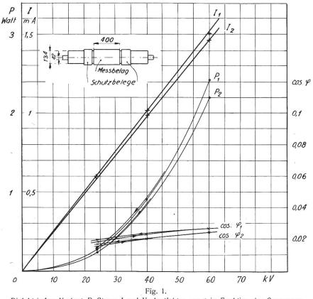
Dielektrischer Verlust P, Strom I und Verlustfaktor  $\cos \varphi$  in Funktion der Spannung zweier Bitubarohre bei  $18^{0}$  C, f=50.
