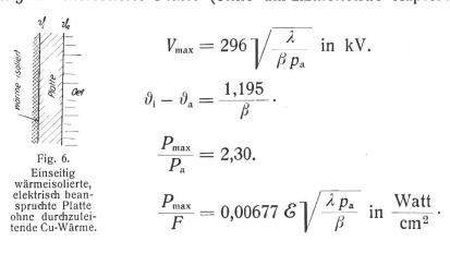
2. Einseitig wärmeisolierte Platte, wenn pro cm² eine zusätzliche Wärmeleistung (Cu-Wärme) durch die Platte geleitet werden muss, welche für sich einen Temperaturabfall  $\Delta \vartheta_{\rm K}$  über die Platte erzeugt.
