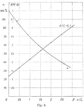
Verhältnis  $\alpha$  der dauernd zulässigen Spannungen des belasteten und leerlaufenden Kabels und höchste Uebertemperatur  $\vartheta_i$ - $\vartheta_a$  der Kabelseele in Funktion des Temperaturabfalls  $\varDelta \vartheta_K$  der Cu-Wärme über die Isolation.
