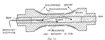
Versuchsrohre mit möglichst verminderter axialer Wärmeableitung.
