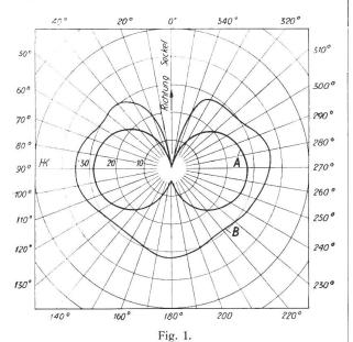
Diagramm der Lichtstärke, aufgenommen in einer durch die Lampenachse gehenden Ebene.
