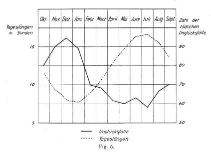
widerspricht Fig. 5. Es ist daraus zu ersehen, dass wir im Dezember noch Beleuchtungsstärken von ca. 9000 Lux aufnehmen müssen und im Sommer sogar 50000 Lux und noch mehr. Man begnügt sich bei der künstlichen Beleuchtung mit Stärken von 10-30 Lux und hält höhere Werte für Luxus und Verschwendung. Die Folgen einer solchen Ansicht sind in Fig. 6 zu erkennen, welche den Zusammenhang zwischen der Beleuchtung in industriellen Innenräumen und der Anzahl der tödlich verlaufenen
