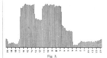
verbrauch entspricht. Die obere Begrenzungslinie stellt eine Leistungsmittelwertkurve dar. Die den Belastungsdurchschnitt überschreitenden Werte zeichnen sich sehr klar als Spitzen ab. Durch die absatzweise Registrierung wird sicher verhindert, dass einzelne Linien ineinander überlaufen oder sich überkreuzen, was dem Registrierbild eine besondere Klarheit verleiht.
