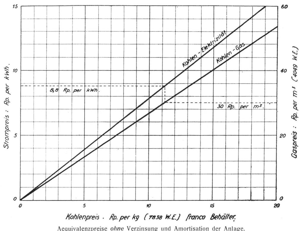
Die Figur gibt die Aequivalenzpreise zwischen Kohlen, Gas und Elektrizität an, wie sie bei diesen Versuchen gefunden wurden, wobei aber eine Amortisation und Verzinsung nicht eingeschlossen ist.
