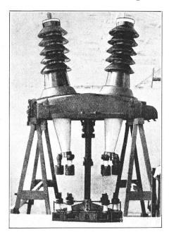
Fig. 20. 100 000 Volt-Schalter, ohne Oelkübel.
