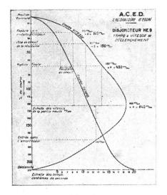
Fig. 8. Ausschaltdiagramm des Oelschalters der Fig. 7.
