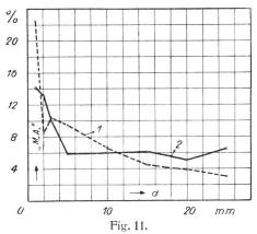
"M. A." für Durchschläge zwischen Diskuselektroden 30 mm Durchmesser; R = 80 mm.
