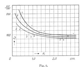
Durchschlagsfestigkeit zwischen Zylinderelektroden.
