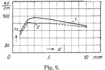
1 Oeldurchschlagsfestigkeit zwischen Diskuselektroden 30 mm Durchmesser; R = 80 mm.
