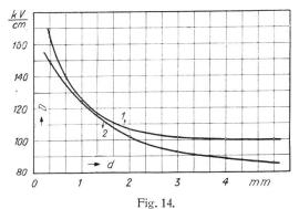
Durchschlagsfestigkeit D zwischen Diskuselektroden 30 mm Durchmesser; R = 80 mm.
