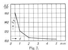
Durchschlagsfestigkeit zwischen Diskuselektroden 30 mm Durchmesser, R = 80 mm.
