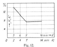
"M. A." für Durchschläge zwischen Zylindern.
