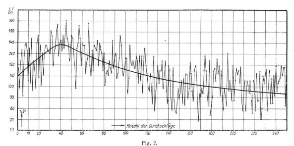
Durchschlagsfestigkeit eines Transformatorenöles in Funktion der Anzahl Durchschläge. Diskusfunkenstrecke 30 mm Durchmesser, R=80 mm, Wartezeit zwischen zwei Durchschlägen: 3 Minuten.
