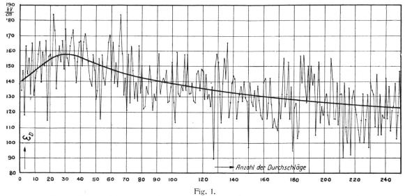
Durchschlagsfestigkeit eines Transformatorenöles in Funktion der Anzahl Durchschläge. Kugelfunkenstrecke 12,5 mm Durchmesser, 3 mm Kugelabstand. Wartezeit zwischen zwei Durchlägen: 3 Minuten.
