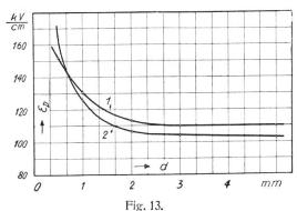
Oelschlagsfeldstärke GD zwischen Kugeln 12,5 mm Durchmesser.
