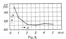
Durchschlagsfestigkeit zwischen Kugeln 12,5 mm Durchmesser.
