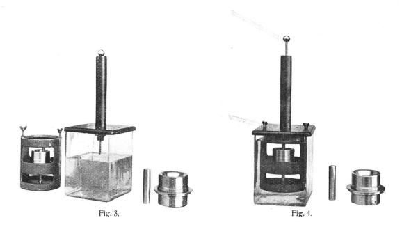
Nimmt man an, dass für die Durchschlagsfestigkeit eines Oeles in einer Zylinderfunkenstrecke die Feldstärke am Innenradius massgebend sei, und trägt man die erhaltene Durchschlagsfeldstärke in kV/cm in Abhängigkeit vom Radius  $R_{\rm i}$  des Innenzylinders auf, so erhält man eine ähnliche Kurve wie für die Luft-
