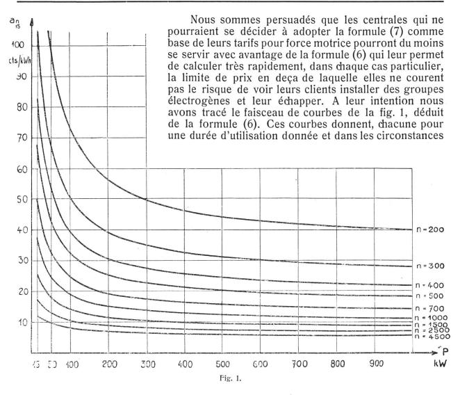
valables actuellement en Suisse, le prix de revient du kWh produit par un groupe électrogène Diesel de puissance comprise entre 15 et 1000 kW fonctionnant toujours à pleine charge. Une simple lecture d'ordonnée sur ces courbes peut remplacer le calcul du prix de revient au moyen de la formule (6).
