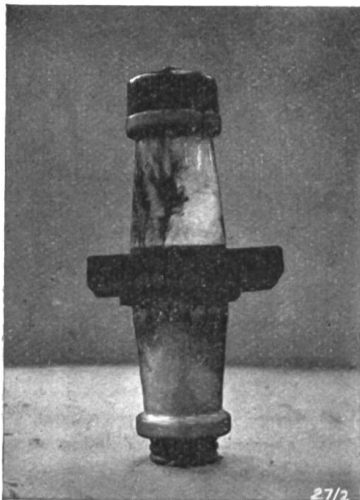
Fig. 4. Ueberschlag am Isolator durch Russniederschlag, vom Schaltergas erzeugt. Durchführungsisolator (3000 V Betr.-Spng.) Ueberschlagsspannung in Luft 32 kV rein Ueberschlagsspannung in Luft 19 kV, nachdem der Isolator unter Spannung in Schaltergas gewesen (30 Abschaltungen zu 20 kW).
