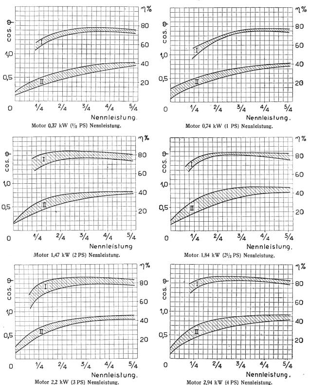
des S. E. V. und zwar auf Versuchen an Maschinen verschiedenster Fabrikate. Die Kurven beziehen sich ausschliesslich auf 4polige Motoren, die somit bei 50 Perioden mit einer Drehzahl arbeiten,
