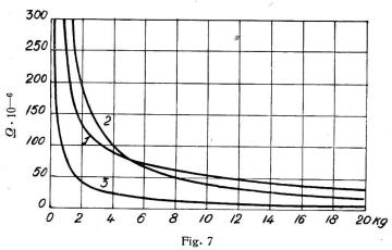
Uebergangswiderstand von Kupferkontakten in Funktion des Drückes. Kurve 1: Punktkontakt, Kurve 2: Flächenkontakt, Kurve 3: gerauhter Flächenkontakt.
