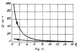
Uebergangswiderstand eines eingeschliffenen Kupfer-Flächenkontaktes in Funktion des Druckes, nachdem derselbe während 5 Minuten auf  $100\,^{\rm o}$  C gehalten wurde.
