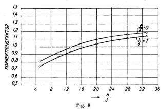
Korrektionsfaktor für die nach Gleichung (20) berechnete Schubkraft.
