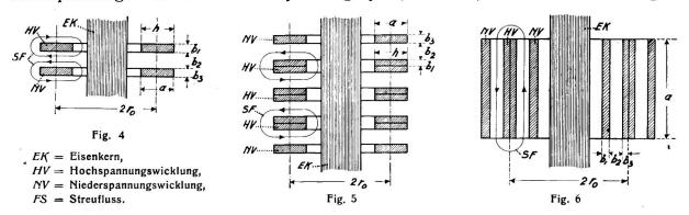
der Fall ist, nur einen Isolationskanal zwischen Hoch- und Niederspannungswicklung besitzt. Für diesen einfachen Fall ist nur eine Umstellung der für den konzentrischen Wicklungsaufbau gewählten Bezeichnungen erforderlich, und zwar ist diese so naheliegend, dass ein Hinweis auf die Fig. 1 und 4 genügen dürfte. a bezw. h ist also stets die Ausdehnung der Wicklung in Richtung der Streukraftlinien, b jene senkrecht dazu.
