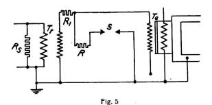
Montage du spintermètre lorsqu'un pôle est à la terre.
